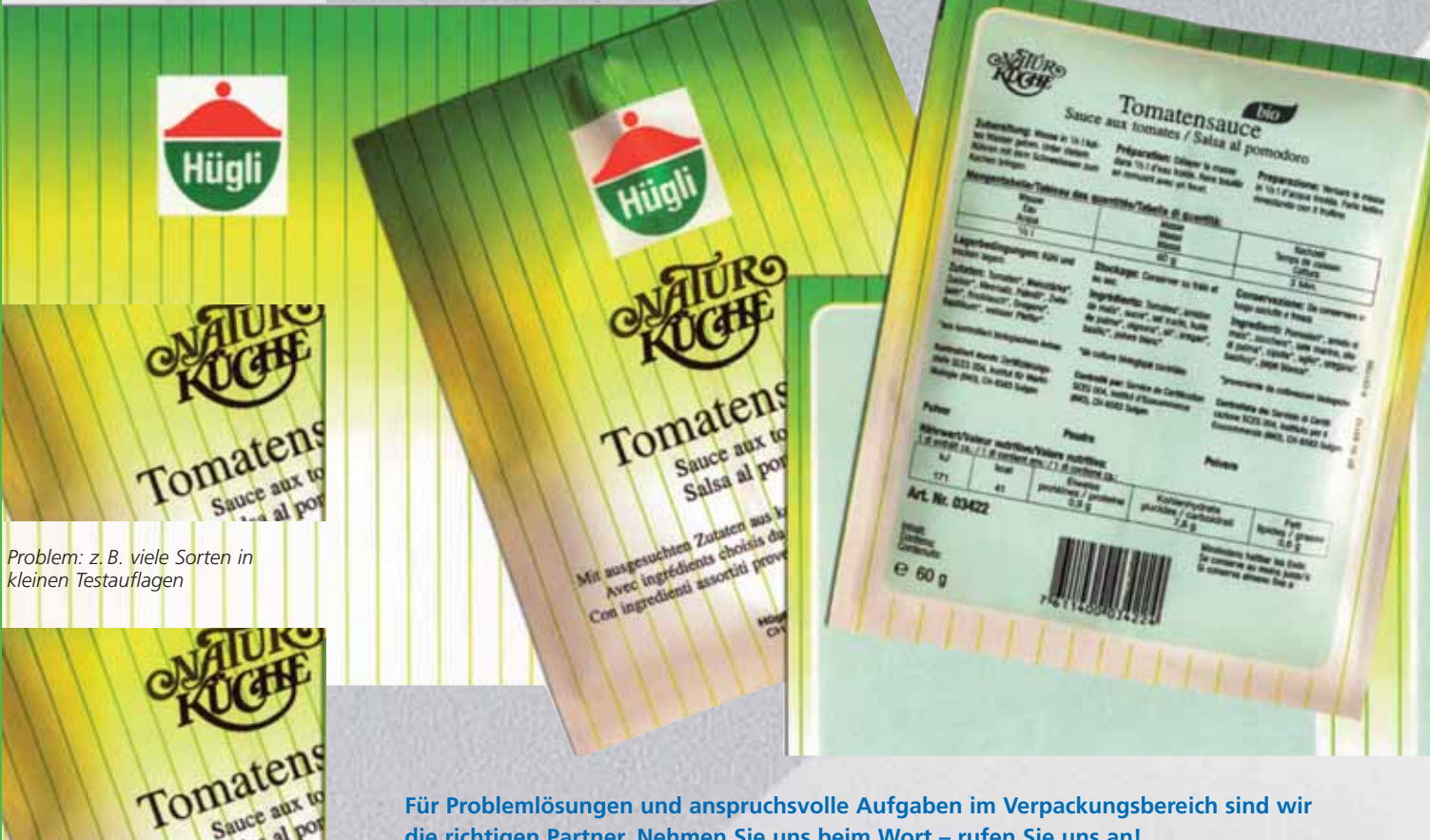
Lösung: Sortenwechsel durch nachträglichen Eindruck der Informationen in einer Farbe.
